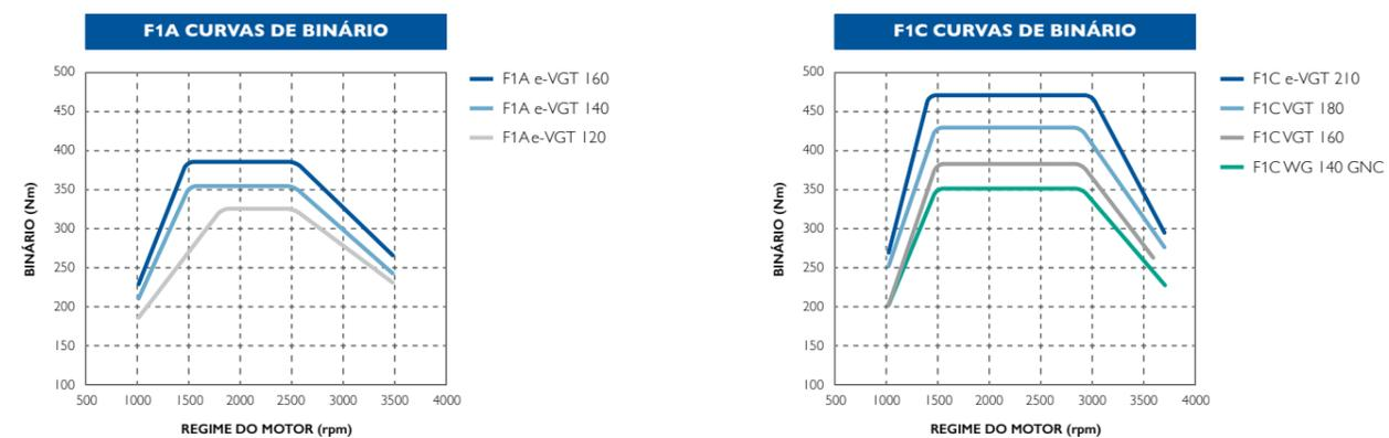
e-VGT: Turbocompressor de Geometria Variável Controlado Eletronicamente; VGT: Turbocompressor de Geometria Variável; WG: WasteGate; GNC: Gás Natural Comprimido
